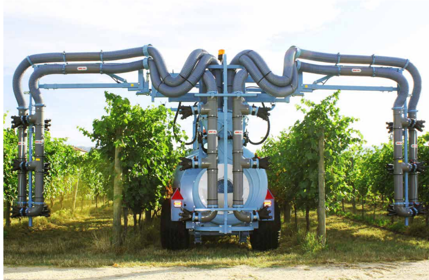
■ Barra parallelogramma 3 file complete / Parallelogram boom for 3 complete rows / Rampe paralléogramme face par face pour 3 rangée complète / Parallelogrammbalken für 3 komplette Reihen/ Barra paralelograma para 3 hileras completas
